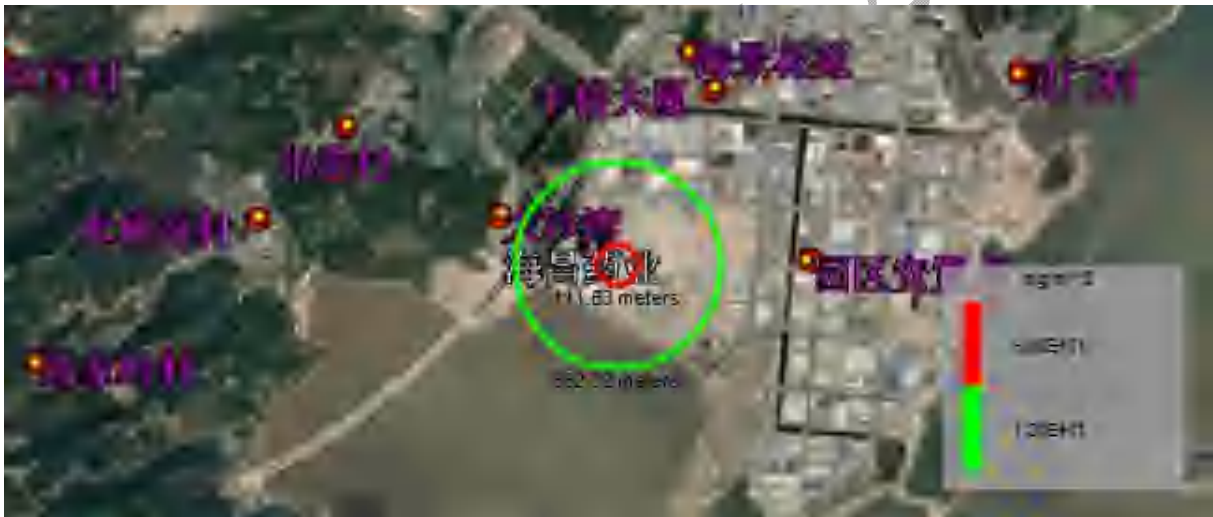
图 6.3.5-8 氯化亚砷储罐泄漏影响预测图
